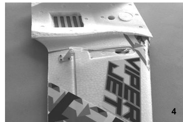
Bild 4 – Verbinden Sie die Anlenkstange mit dem Servo und den Ruderhorn.
