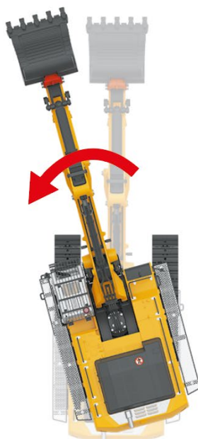
Oberwagen nach links drehen Turn the uppercarriage to the left
