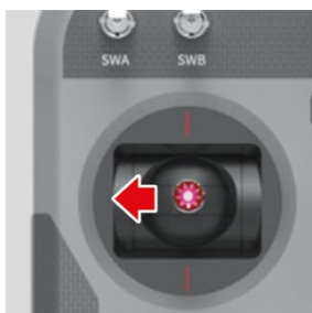
Oberwagen nach links drehen Turn the uppercarriage to the left
